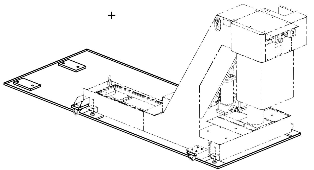
Die Tropfwanne gemäß Zeichnung ist ausgelegt für die Aufstellung der Grundmaschine einschließlich Späneförderer. Für Reinigungsanlage, Werkstoffnachschnitt und weitere Anbaugeräte sind bei Bedarf weitere Tropfwannen nötig. Nicht berücksichtigt sind individuelle Gegebenheiten, wie z.B. Breite der Umfassung der Maschine, eingelegter Laufrost, Platzverhältnisse sowie die Aufstellung externer Ausrüstungskomponenten wie z.B. Werkstückhandhabung, etc.
