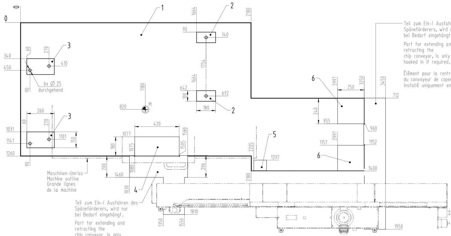
Teil zum Ein-/ Ausfahren des Späneförderers, wird nur bei Bedarf eingehängt.
