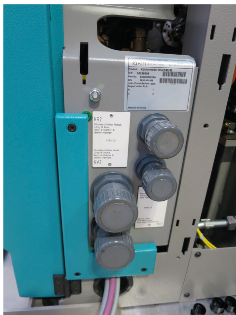
Photo 01: Raccords de réfrigérant sur multibroche
