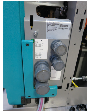
Photos 01 et 02: Emplacement des liaisons mécaniques et des fluides sur multi-broche.
