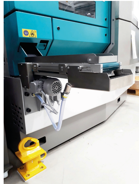
Photos 02 et 03: Exemple d'un MS40-6, avec bande transporteuse à l'extérieur du tour
