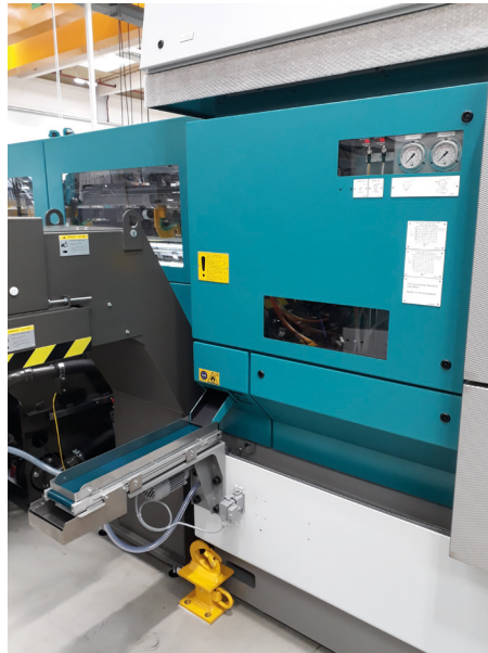
Photos 02 et 03: Exemple d'un MS40-6, avec bande transporteuse à l'extérieur du tour
