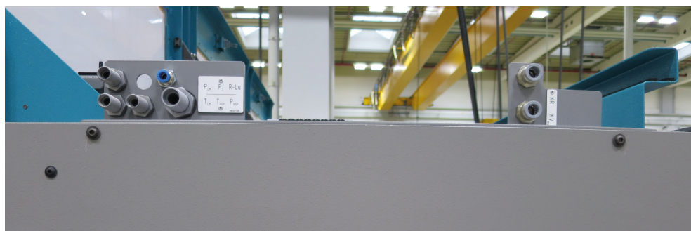
Photo 01: Exemple de raccords de fluides sur un magasin de chargement MBL
